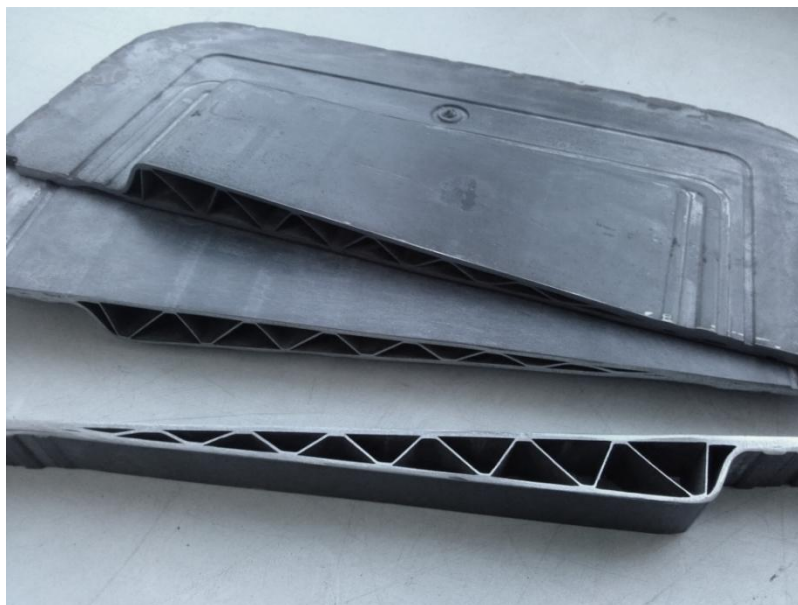
Рисунок 3.25 – Клиновидная панель с поперечным гофром из титанового сплава BT20
