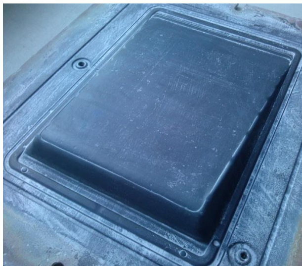
Рисунок 4.19 – Трёхслойная клиновидная панель с переменным шагом ребер из сплава OT4-1
