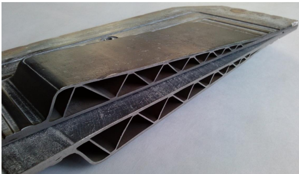
Рисунок 4.20 – Разрез трёхслойной клиновидной панели с переменным шагом ребер из сплава ОТ4-1
