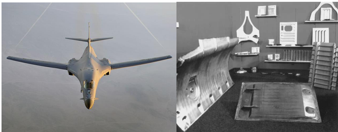
Рисунок 1.3 - Конструкции самолёта «В-1В», изготовленные методом ПТФ/ДС
